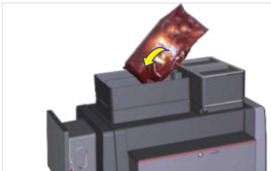
2. Automatenaugliches Pulver einfüllen.
