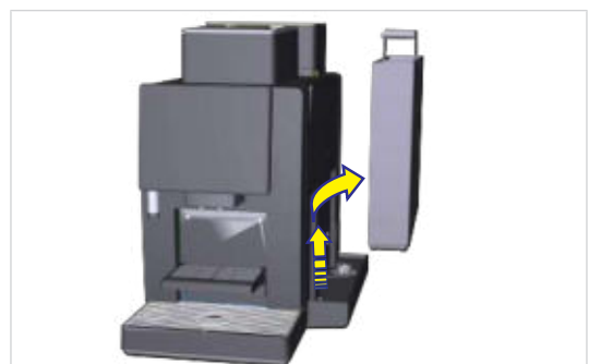
2. Den Wassertank anheben und entnehmen.
