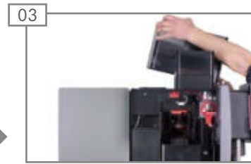
Bohnenbehälter nach oben abheben. Bohnenbehälter leeren.
