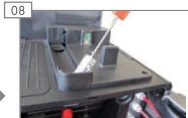
Pulverrutsche mit Bürste reinigen.
