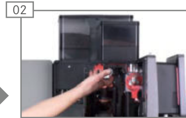
Verriegelungsschieber ganz nach vorne ziehen.
